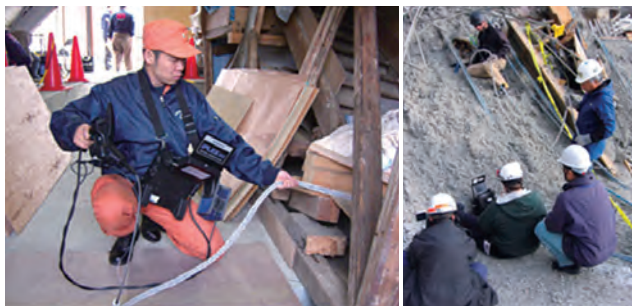
図4 能動スコープカメラと事故現場への適用
