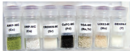
図3 原子力レアメタル分離用ハイブリッドマイクロカプセル
