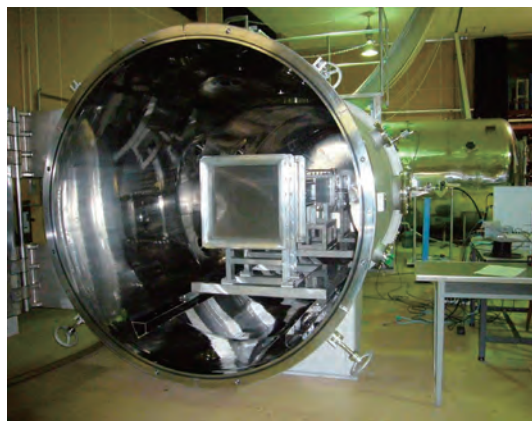
図8 世界で唯一の火星大気風洞 (MWT)
